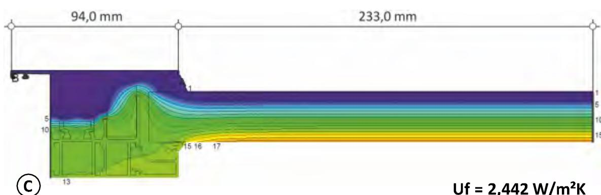
\* EN 10077-2 standardına göre; iç ortam sıcaklığı 20°C, dış ortam sıcaklığı 0°C ve bağıl nem %50 olarak alınmıştır.
